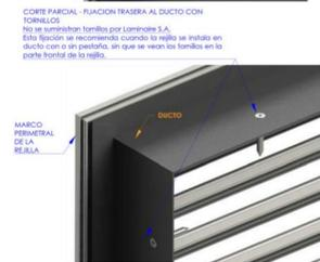
FIJACION TRASERA A DUCTOS, CON TORNILLO AL MARCO. No se suministran tornillos por Laminaire S.A. Esta fijación evita que se vea la fijación en la parte frontal de la rejilla.
