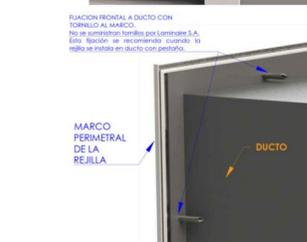
FIJACION FRONTAL A DUCTOS, CON TORNILLO AL MARCO. No se suministran tornillos por Laminaire S.A. Esta fijación se recomienda cuando la rejilla se instala en ducto con pestañas.
