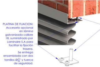
FIJACION A MAMPOSTERIA/ CONCRETO CON TORNILLO DE EXPANSION Ø12. No se suministran por Laminaire S.A.
